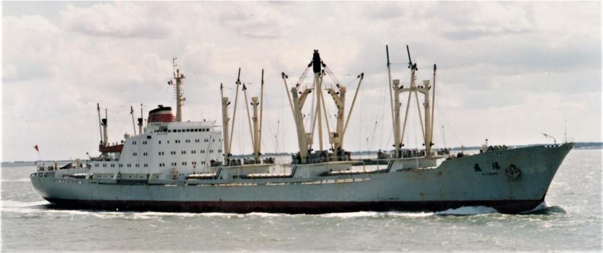
YI YANG at Antwerp, 60-ton Stülcken derrick (DDG Hansa/shipping.com).
