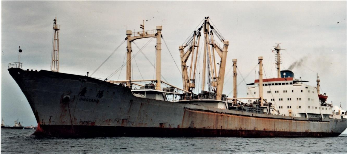
QING YANG showing full Stülcken derrick layout (DDG Hansa/shipping.com).
